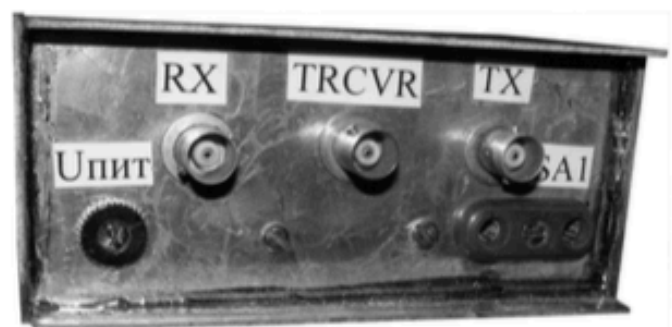
Рис. 3. Фото задней панели РЧ-переключателя
