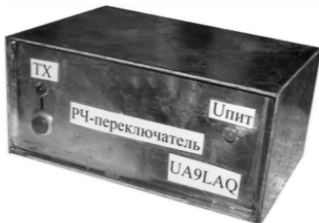
Рис. 5. РЧ-переключатель. Общий вид конструкции. Надписи произведены на обычной бумаге с помощью лазерного принтера и приклеены прозрачным скотчем. Изготовление РЧ-переключателя производилось с целью реального применения в практике радиолюбителя, не на выставку (Hi!)
