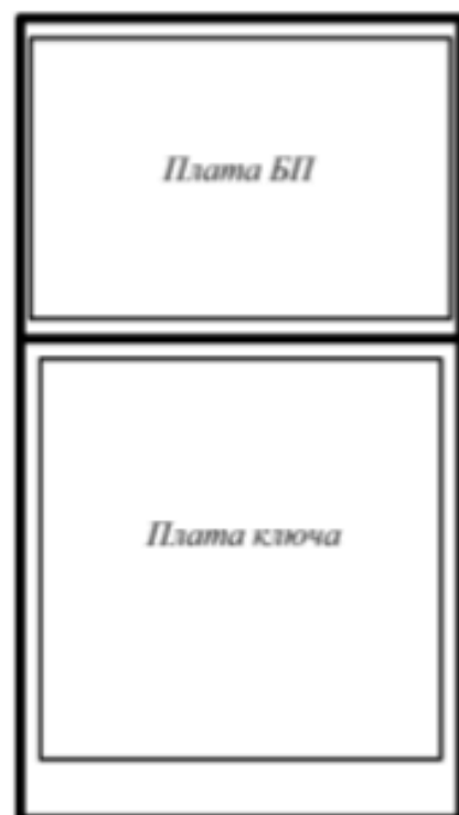
Рис. 2. Проект размещения плат в корпусе ключа: отсек БП - 110x80 мм, отсек ключа - 110x120 мм
