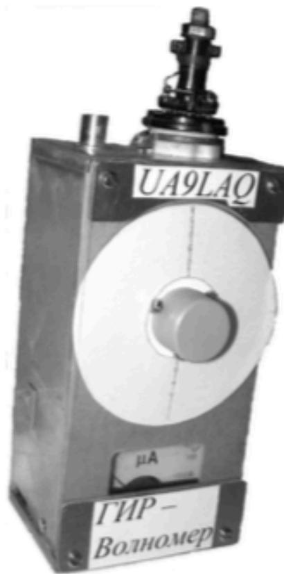
Рис. 14. Фото прибора перед настройкой. Видны линии визиров и отверстия для постановки значений частот генерации ГИР
