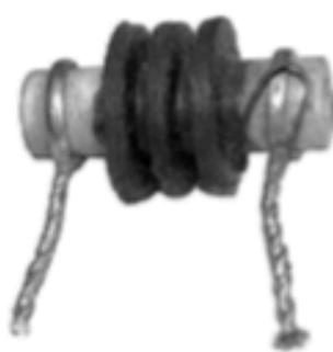
Рис. 7. Дроссель. Несмотря на высококачественную намотку у дросселя, есть и нюансы: его выводы представляют собой два короткозамкнутых витка, что влияет на добротность катушки, а залитые смолой витки, хоть и защищают обмотку от внешних воздействий, со временем также оказывают на ней негативное воздействие (к смоле прилипают частицы пыли и свойства самой смолы со временем меняются)
