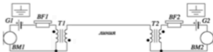
Рис. 7. Вариант ПУ с использованием "земляных" гальванических элементов и включением T1 и T2 по автотрансформаторной схеме
