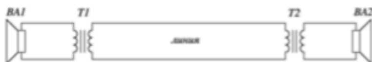
Рис. 2. Простое дуплексное переговорное устройство с использованием абонентских трансляционных громкоговорителей. Схема принципиальная электрическая
