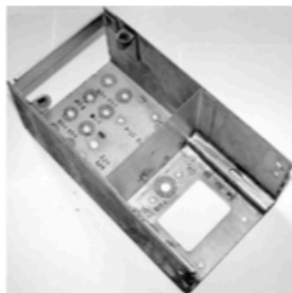
Фото 2. Вид заготовки из шасси блока усиления мощности радиостанции “Кама-С”. Вид изнутри
