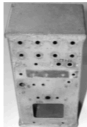
Фото 5. Вид готового корпуса ГИР. Вид на торцевую стенку корпуса и лицевую панель, на которую устанавливаем фальшпанель из пластика или электрокартона и обращаемся далее к [1]
