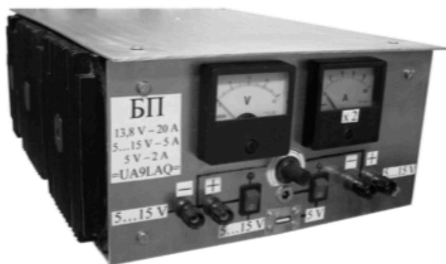
Фото 11. Общий вид комбинированного БП. В центре верхней панели видна головка винта, удерживающего блок мостового выпрямителя для вспомогательных стабилизаторов.
