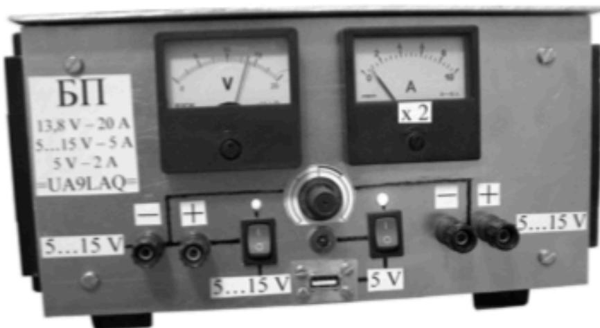
Фото 9. Лицевая панель комбинированного БП. БП включен в сеть переменного тока, основной стабилизатор нагружен резистором 10 Ом (зажимные клеммы на задней панели блока). Включены и дополнительные стабилизаторы, о чём свидетельствуют светодиоды
