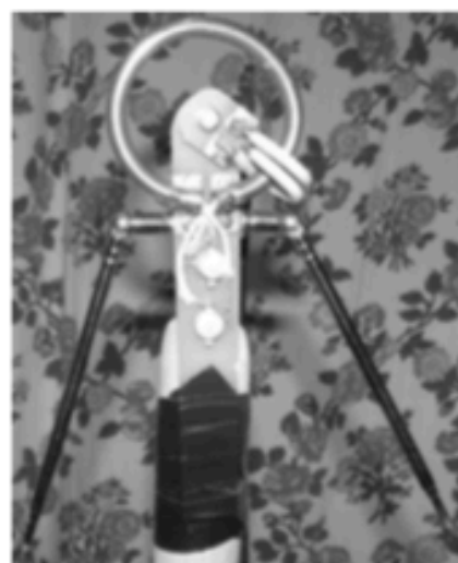
Фото 2. Вид антенны UA6AGW/R3PIN с наклонным диполем; чтобы показать вход и выход проводников внутренних рамок, подстроечный конденсатор внешней рамки временно убран
