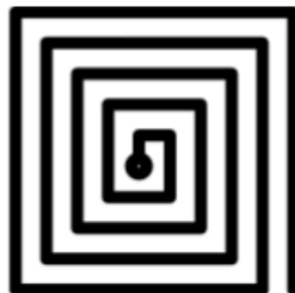
Рис. 3. Эскиз "печатной" катушки – элемента дипольной антенны с "намоткой" по часовой стрелке
