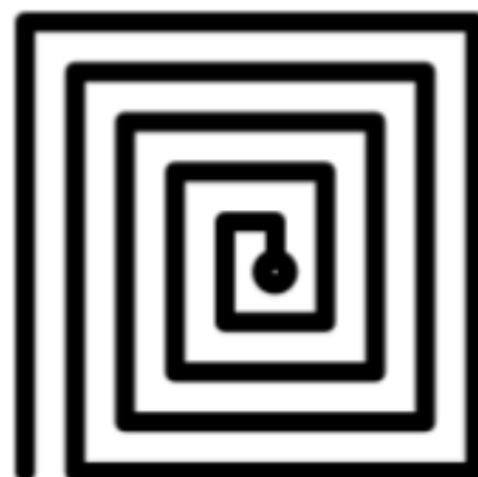
Рис. 2. Эскиз "печатной" катушки – элемента дипольной антенны с "намоткой" против часовой стрелки
