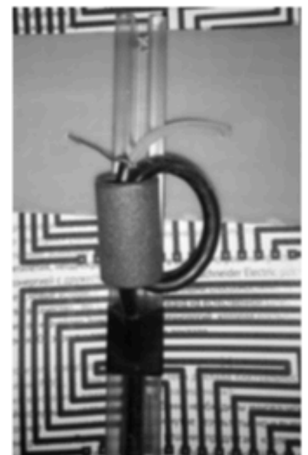
Рис. 11 – вид подвода питания антенны с её тыльной стороны
