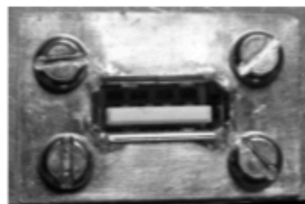
Фото 4. Ответная часть USB-соединителя прикреплена к передней стенке БП
