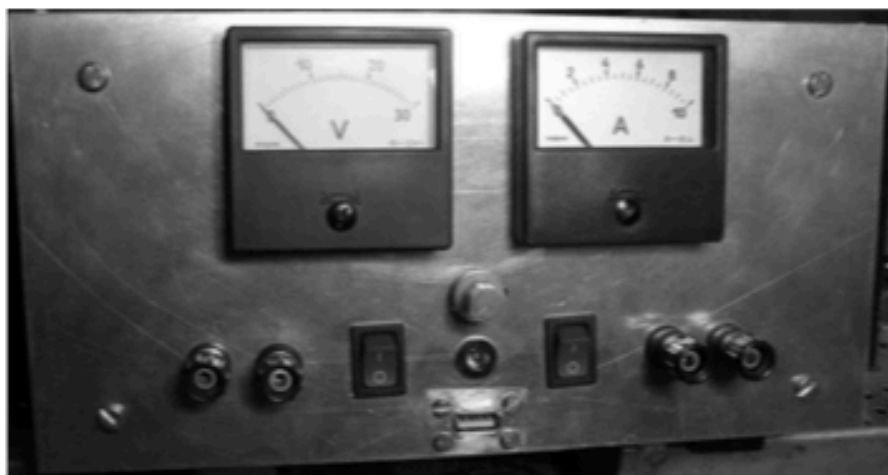
Фото 5. Вид передней стенки комбинированного блока питания. Внизу закреплён USB-соединитель
