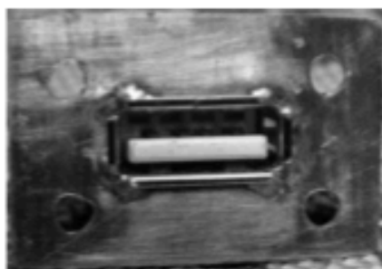
Фото 3. Отверстия для крепления (диаметром 2...3 мм) просверлены по месту
