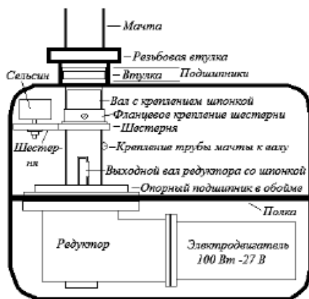
Рис. 4. Эскиз исполнительного узла поворотного устройства. Фронтальный вид
