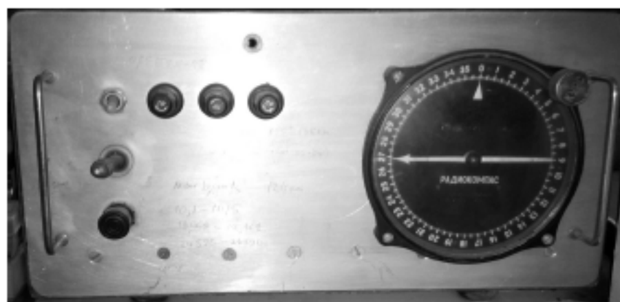
Фото 5. Индикаторная часть и БП ПУ собраны в корпусе от приёмника радиостанции “Полоса-2”
