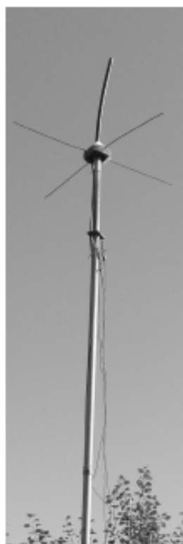
Рис. 1. Антенна на двухметровый диапазон – вертикальный шлейфовый вибратор [3], излучатель изготовлен из толстого коаксиального кабеля
