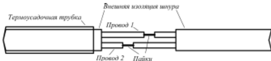
Рис. 1. Спайка шнура. Термоусадочная трубка длиной с запасом, не менее, чем по сантиметру, надвигается на места пайки и обсаживается феном поверх внешней изоляции шнура
