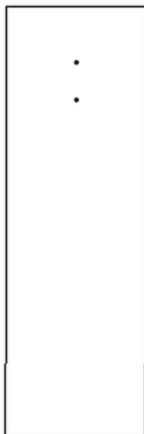
Рис. 7. Эскиз боковых панелей корпуса. Обе – одинаковы. Их размер: 230x75 мм. В обеих панелях имеются отверстия, расположенные по продольным осевым линиям: на расстоянии 30 мм от ближайших торцов – отверстия диаметром 2,5 мм для крепления пайкой "холодных" концов катушки спирального резонатора, на расстояниях 50 мм – для установки РЧ розеток (для крепления розеток типа BNC выпиливается отверстие сложной формы с малым диаметром 9 мм и большим диаметром 12 мм – определяется по месту под имеющиеся розетки)
