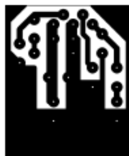
Рис. 11. Эскиз монтажной платы 1/2 мостового УЗЧ (УМ) на ИМС K174УН14 (TDA2003) для эксплуатации в сложной электромагнитной обстановке. Вид со стороны проводников. Размеры платы: 32,5x40x1,5 мм
