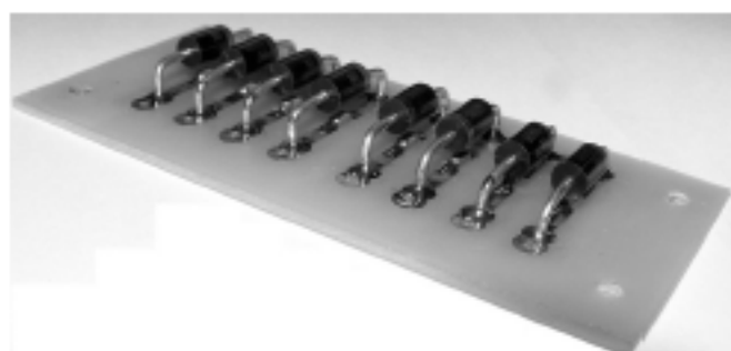
Рис. 5. Фото с установленными на плате диодами 1N5408, под ними видны впаиваемые, согласно схеме рис. 1, SMD-конденсаторы
