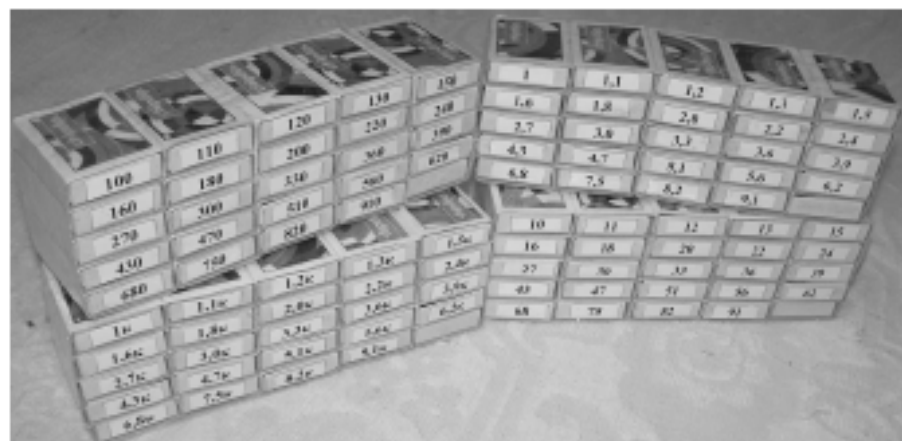
Рис. 1. Фото готовых блоков для хранения мелких радиодеталей
