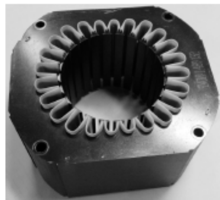
Рис. 2. Фото сердечника статора электродвигателя, подготовленного для намотки обмоток будущего тороидального трансформатора
