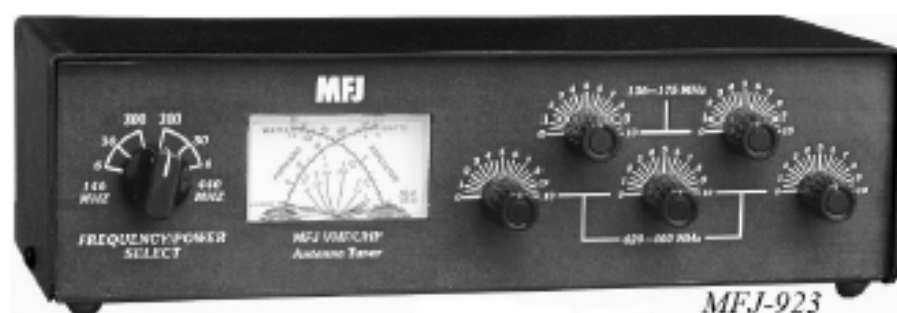
Рис. 7. Фото промышленного антенного тюнера; как видно, СУ на более высокочастотный диапазон (420...460 МГц) содержит больше органов настройки, чем на диапазон 136...175 МГц и органы настройки для разных диапазонов индивидуальны
