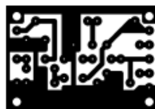
Рис. 2. Эскиз монтажной платы ГИР. Вид со стороны печатных проводников. Размеры: 40x27,5x1,5 мм
