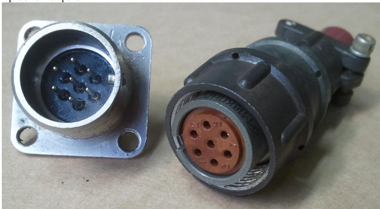
Рис. 1. Слева - 7-штырьковая приборная вилка, справа – комплектная к ней кабельная розетка
