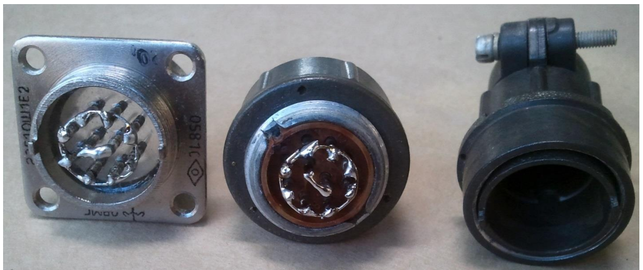
Рис. 5. Вид импровизированного РЧ соединителя со стороны паяк.
