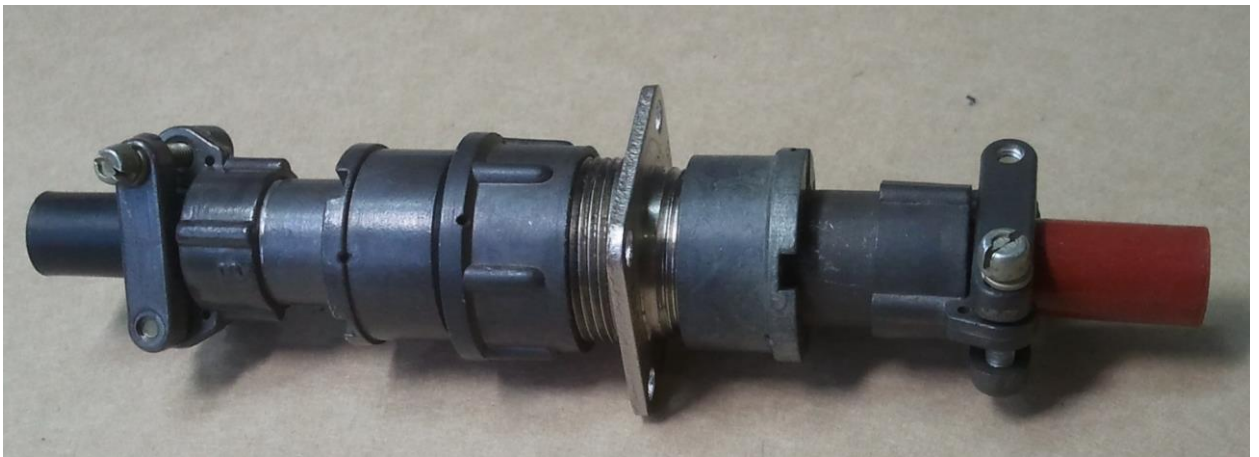
Рис. 3. Кабельное РЧ соединение на основе низкочастотного соединителя
