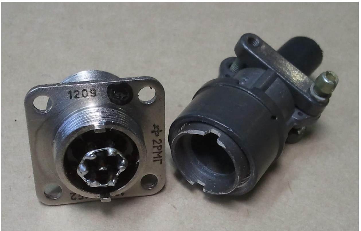
Рис. 4. Доработка дополнительного хвостовика к кабельному РЧ соединению. Имеющиеся штырьки на хвостовике, взятом от другой (второй) кабельной розетки, спилены, на их месте надфилем сделаны углубления. Слева – всё та же приборная вилка, справа - дополнительный хвостовик для обеспечения соединения на кабеле
