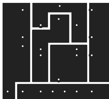
Рис. 2. Эскиз платы звукового генератора при её изготовлении с помощью резака. Размер платы: 45x40x1,5 мм
