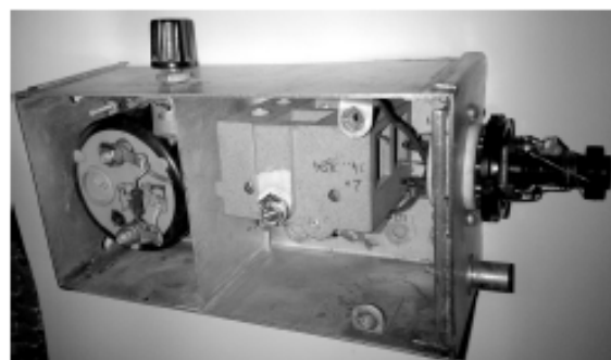
Рис. 4. Корпус ГИР из блока усилителя мощности передатчика радиостанции КАМА-С
