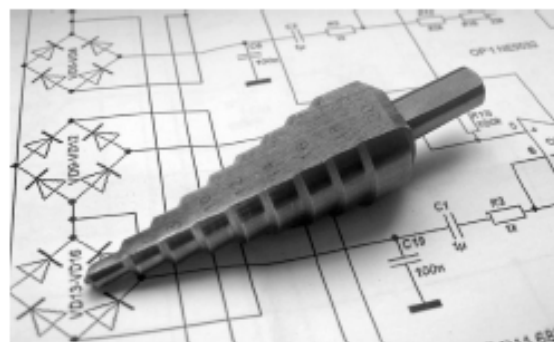
Рис. 5. Ступенчатое сверло для рассверловки отверстий
