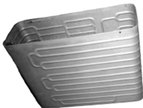
Рис. 3. Корпус из “морозилки” старого холодильника
