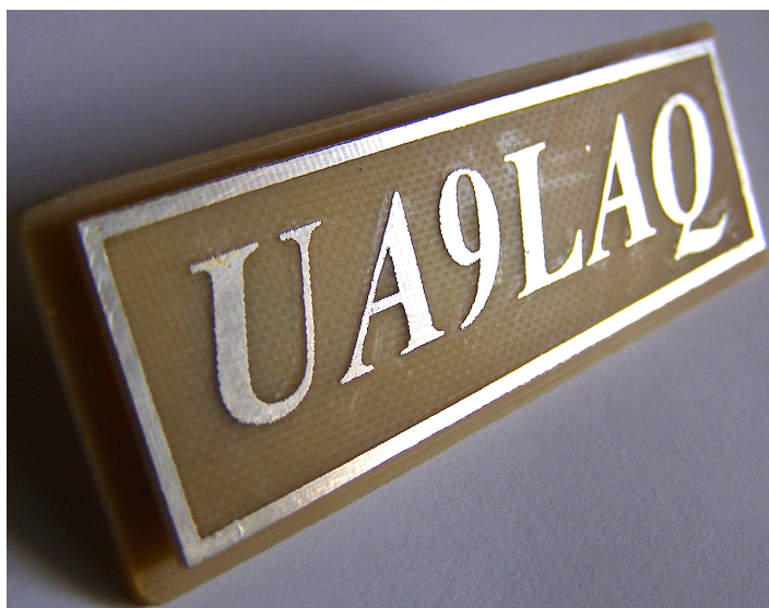
Рис. 3. Фото готового значка (буквы и окантовка пролужены)
