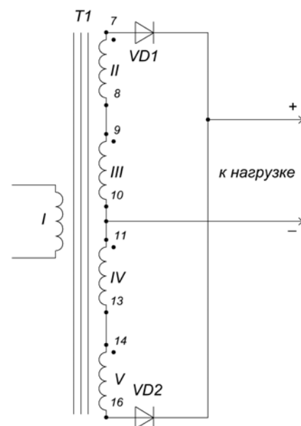
Рис. 3. ТН-60: комбинация обмоток с двухполупериодным выпрямлением, выходное напряжение 12,6 В
